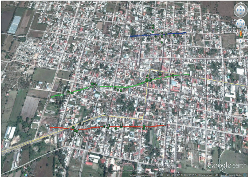
Figura 3. Localización de fallas por subsidencia en Jocotepec, Jalisco. Fuente: Google Earth
