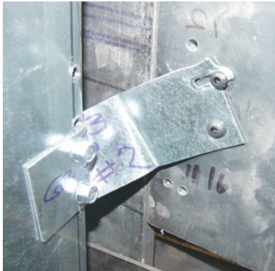
Figura 9. Modo de falla a cortante de clip s_1 y grafica esfuerzo-deformación. Fuente: fotografía y edición del autor.
