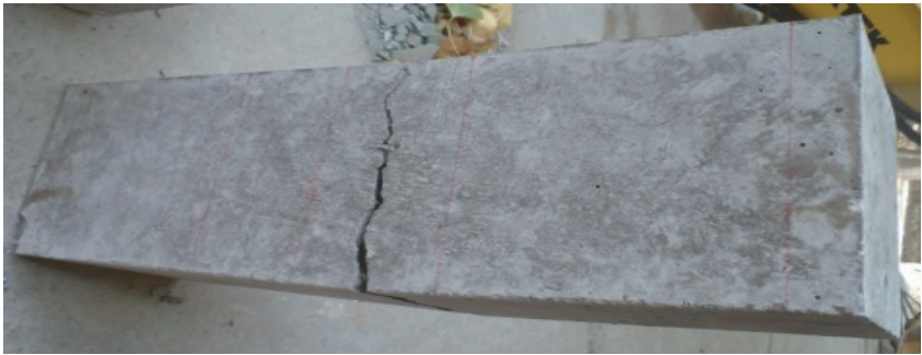
Figura 6. Patrón de agrietamiento en ensayos de vigas normalizadas.
