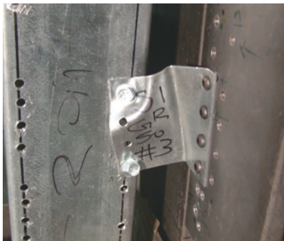
Figura 9. Modo de falla a cortante de clip s_1 y grafica esfuerzo-deformación. Fuente: fotografía y edición del autor.
