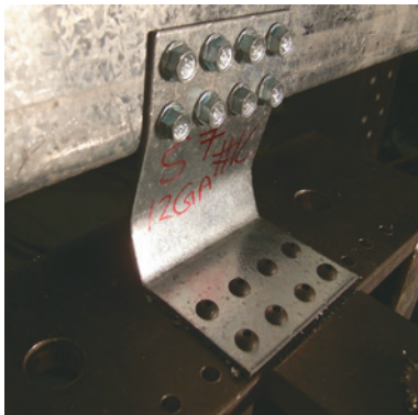
Figura 5. Modo de falla de clip s7 y su correspondiente curva esfuerzo-deformación. Fuente: fotografía y edición del autor.
