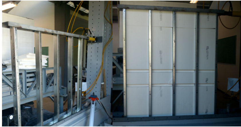
Imagen 1. Marco con recubrimiento de poliestireno y marco sin recubrimiento. Fuente: Luis A. Hernández, 2012.
