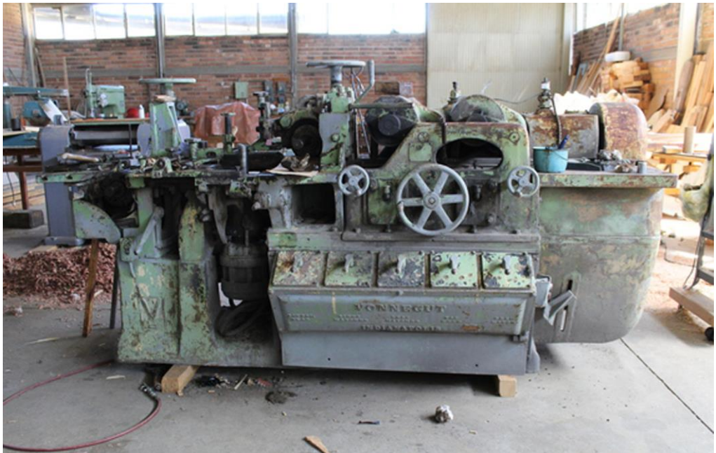
Fig. 2. Maquinaria para la creación de molduras, a partir de las “tiras de madera” en la fábrica de cuadros “Monte Escobedo”. Fotografía: Antonio Mercado Galván.
