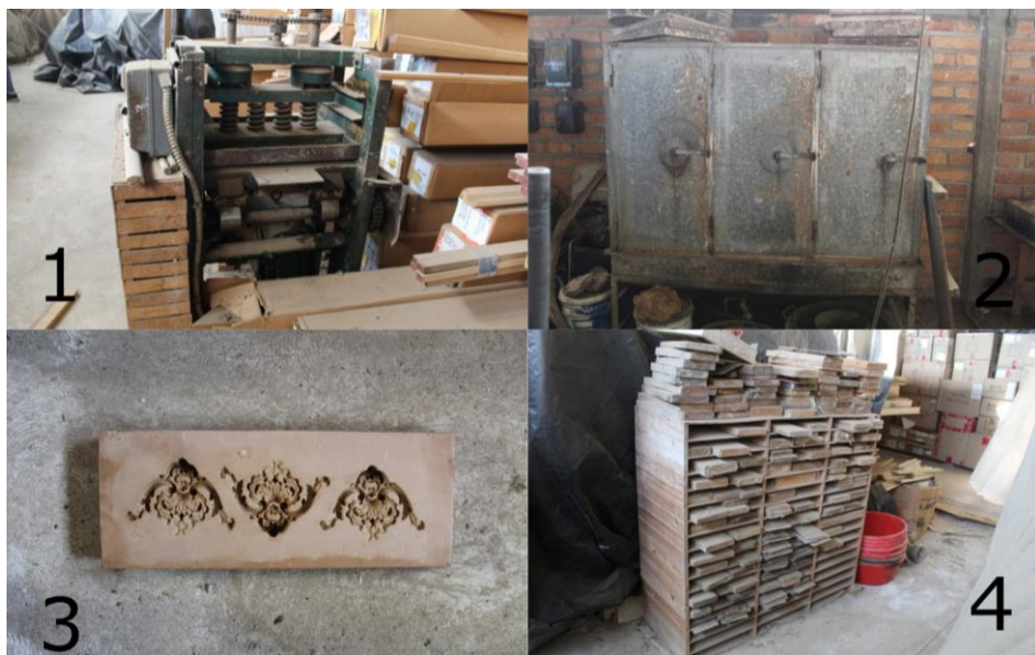
Fig. 7. 1. Prensa utilizada para la realización del campo . 2. Horno donde se cocía el campo . 3. Molde donde se colocaba la masilla y se producía la forma requerida. 4. Moldes para la creación del campo . Fotografías y edición: Antonio Mercado Galván.
