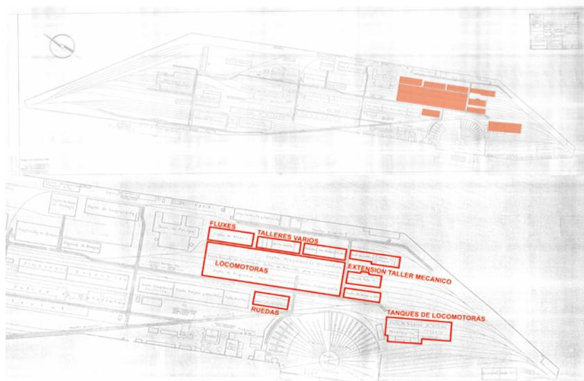
Figura 9. Plano General de los Talleres de Aguascalientes donde se muestran los subdepartamentos del Taller de Locomotoras. Plano realizado por Marlene Barba Rodríguez a partir del dibujado en febrero de 1944 por el Departamento de Vía y Edificios de los Ferrocarriles Nacionales de México. Fuente: CEDIF.
