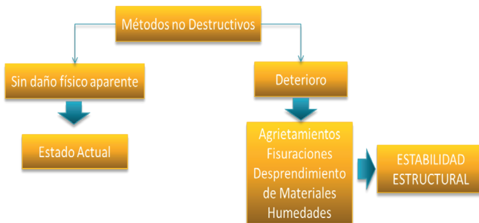
Figura 7. Uso de los métodos no destructivos para el análisis de las construcciones. Fuente: Elaboración propia
